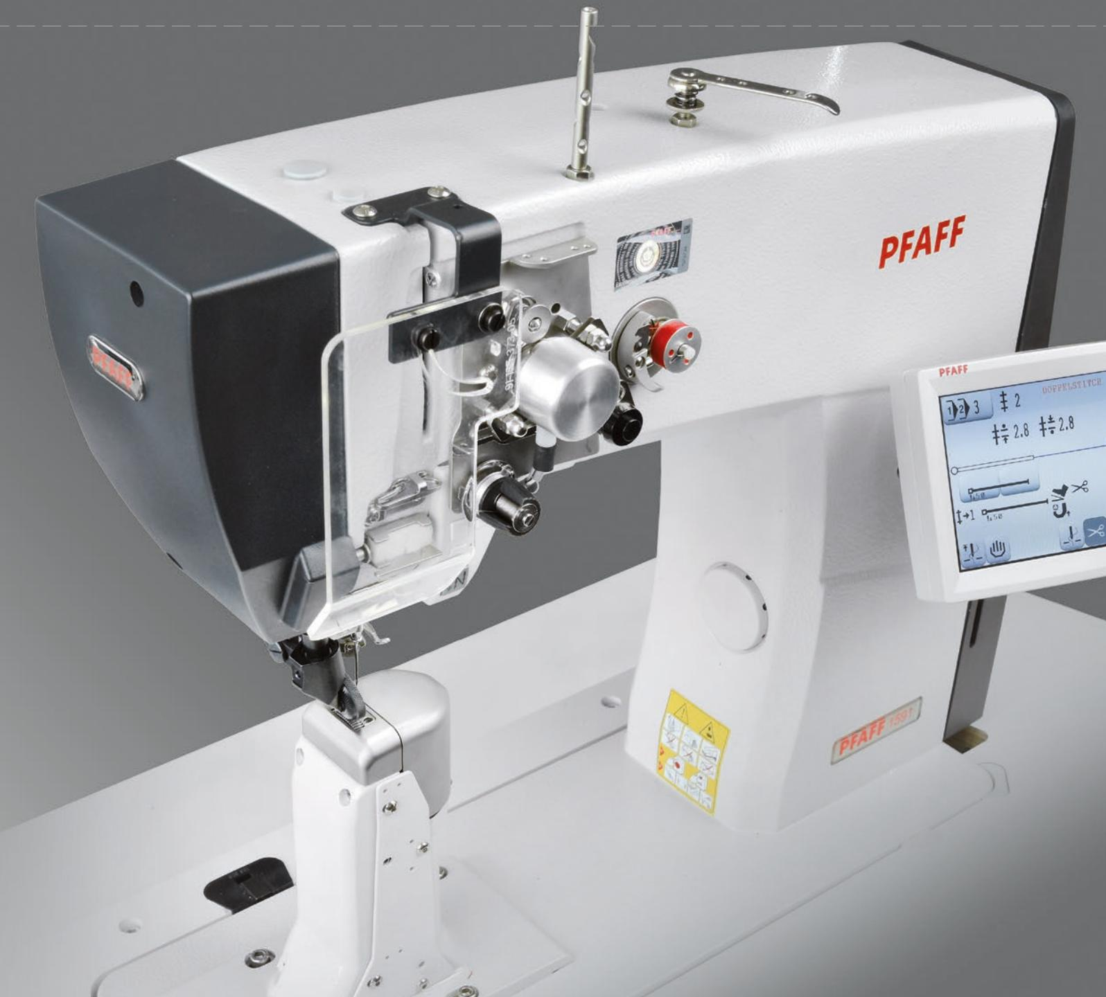
Schneltaster (vorwärts/rückwärts) und 3 Funktionstaster mit den wichtigsten Einstellmöglichkeiten im Griffbereich der Bedienperson. Integriertes LED-Licht.
