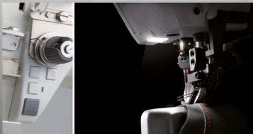
Neu: Einfach justierbare Fadenabschneideeinrichtung (-900/81) mit verstärktem Fänger- und Messersystem für kurze Fadendenen (bis 15/3 syn.)
