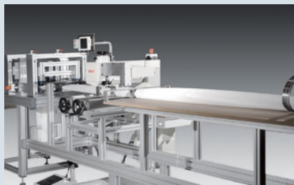
百福4504/4507 - 超声波或者热吹风工作站, 用于闭合长焊迹的工业制品
