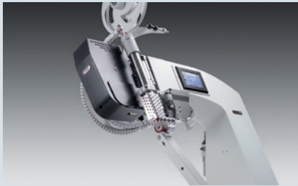
百福8303i - 新款可编程控制的热风压胶焊接机
