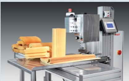
百福8317 - 单焊接头超声波焊接工作站, 配有送料台
