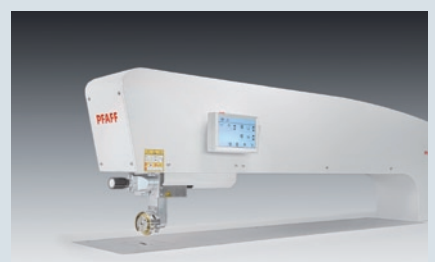
百福8312—可电子程控的平台式超声波焊接机 (既可进行裁剪密合 亦可裁边加焊接复合同时进行)
